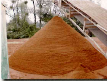
02 材料(レッドクレイ) 良質なレンガを粉砕したフランス産のレッドクレイは粒径が非常に細かく、他に類を見ない均一性の高い材料。
