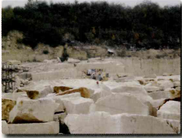
01 材料(石灰石原石) バリ郊外にある石炭石採取場。原石を粉砕器に投入して粒径が2ミリ以下のきわめて細かい材料を製造。
