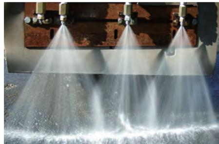
洗剤で除去した汚れは、手押し式高吐出水量型の高压洗浄機を使って洗い流します。従来のガンノズルタイプでは、洗浄ムラがでやすい欠点がありましたが（写真右）、この専用洗浄機を使うことによって、均一に洗浄を行うことが可能になりました。
